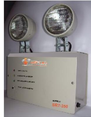
Los sistemas de iluminación de emergencia son denominados Autoenergizados básicamente porque cuentan con una batería que permite al momento de un corte de energía poder encender una luminaria independiente del sistema de normal del recinto, lo que permite visualizar puertas de escape, escaleras, pasillos y así evitar obstáculos que pudiesen producir daños o lesiones graves a las personas en la evacuación.
